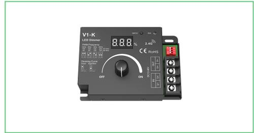
Leistungsstarker 1-Kanal LED-Dimmer für 12–48 V DC. Bis 20 A Ausgang. Ideal für einfarbige LED-Streifen mit Konstantspannung. Einfach, sicher, effizient.
